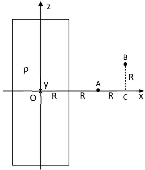
A) Per simmetria il campo  $\vec{E}$  è radiale con coordinata  $r$ , e direzione  $\hat{r}$ , quindi  $\vec{E}(r) = E(r) \cdot \hat{r}$ . Il campo elettrico si può calcolare utilizzando il teorema di Gauss applicato ad un cilindro di raggio  $r$  ed altezza  $h$  con l'asse coincidente con l'asse  $z$  del cilindro.
